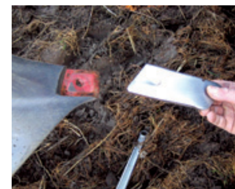
De ingelegde schaarpunt verlaagt de trekkracht en is gemakkelijk te verwisselen. De punt is echter niet omkeerbaar.
