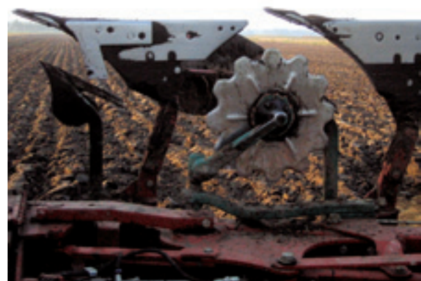
Bij het type LB zit op de eerste schaar een tipkouter omdat op de eerste schaar geen schijfkouter kan. Dit verkort en verlicht de ploeg.
