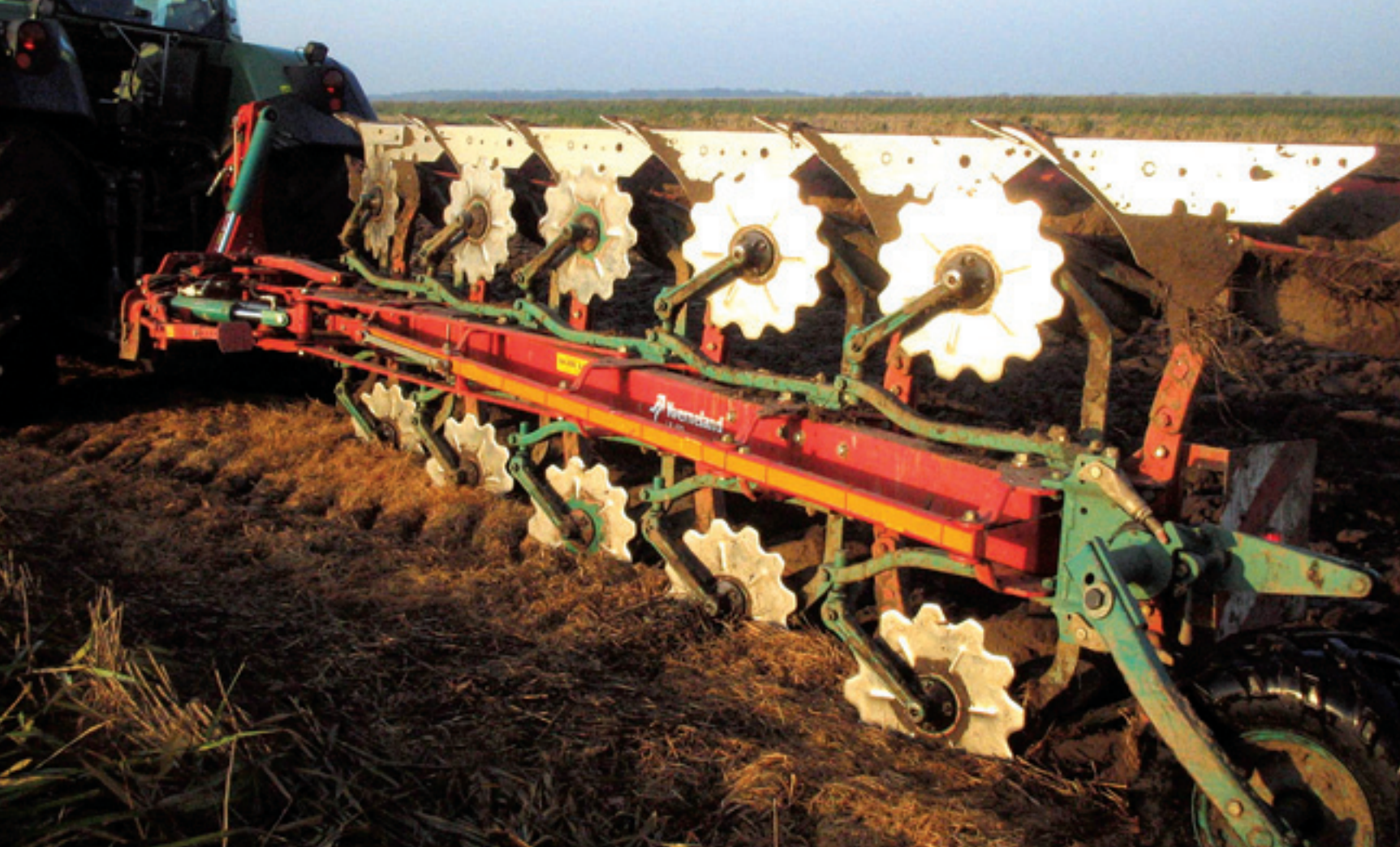
Loonbedrijf van Drunen uit Elshout heeft de 6-schaar in de hef van een Fendt 916 van 200 pk (147 kW). Bij het wentelen gaat de ploeg automatisch naar de smalste werkbreedte om het wentelen te vergemakkelijken.
