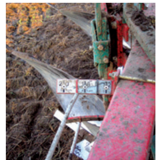
Op de ploeg is gemakkelijk vanuit de cabine de ingestelde snijbreedte af te lezen.
